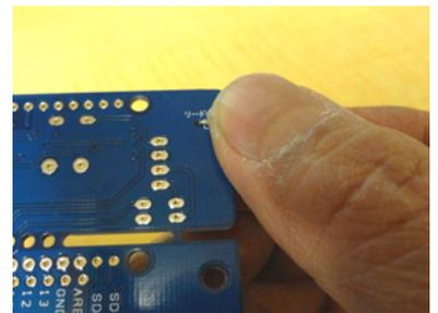
4 基板の端を使って、もう一方のリードを曲げます。
