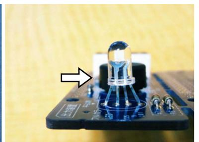
13 はんだ付けが終わったら光拡散キャップをかぶせておきます。
