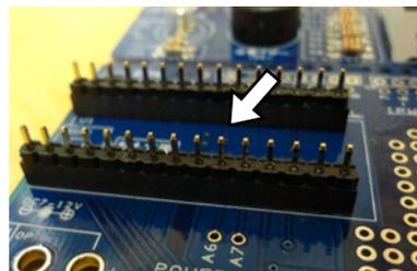
16 ピンの上にマイコンボードをのせます。基板の印刷の向きにUSBコネクタが向くようにします。
