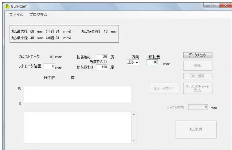
2. 各欄の入力が終わったらデータのチェックを行います。この部分では、カムの傾斜がきつすぎないか、指定されたストローク範囲内に入っているかを判定します。データチェックボタンを押すと圧力角が計算され、判定が表示されます。圧力角が 40° を超えると入力を見直すようメッセージが表示されます。
